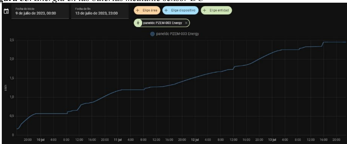
Figura 55. Energía en las baterías mediante sensor DC
