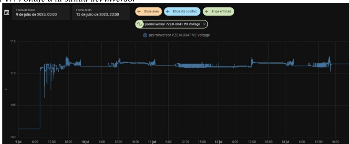
Figura 47. Voltaje a la salida del inversor
