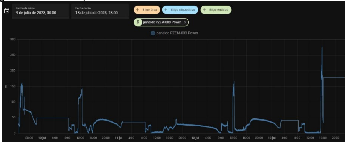
Figura 56. Medición de potencia en las baterías sensor DC
