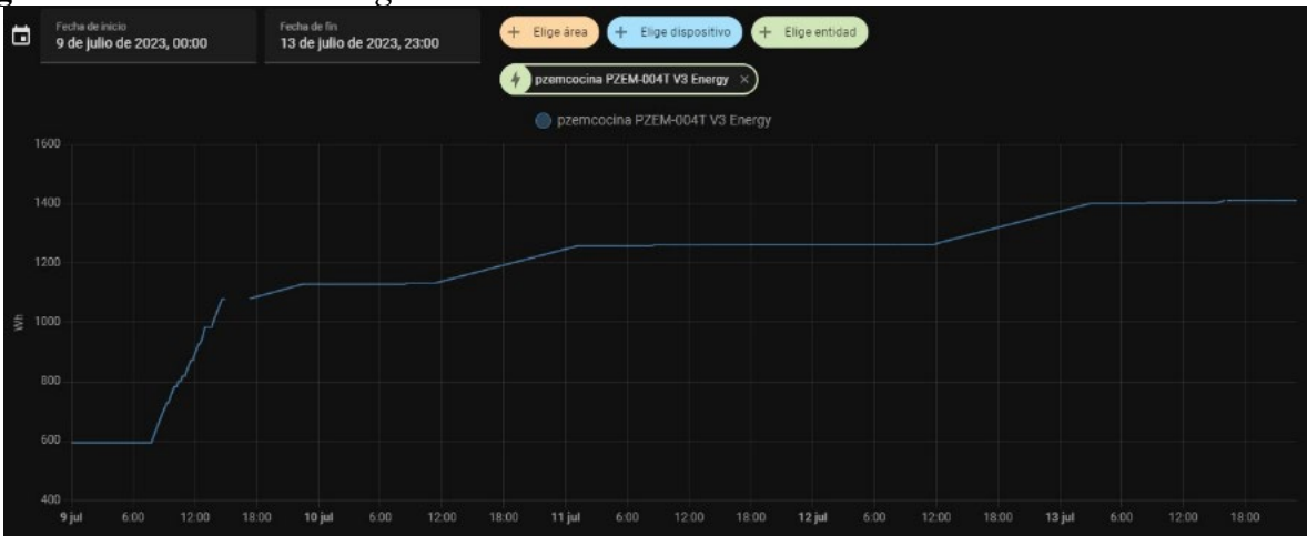
Figura 49. Medición de energía sensor ubicado en la cocina
