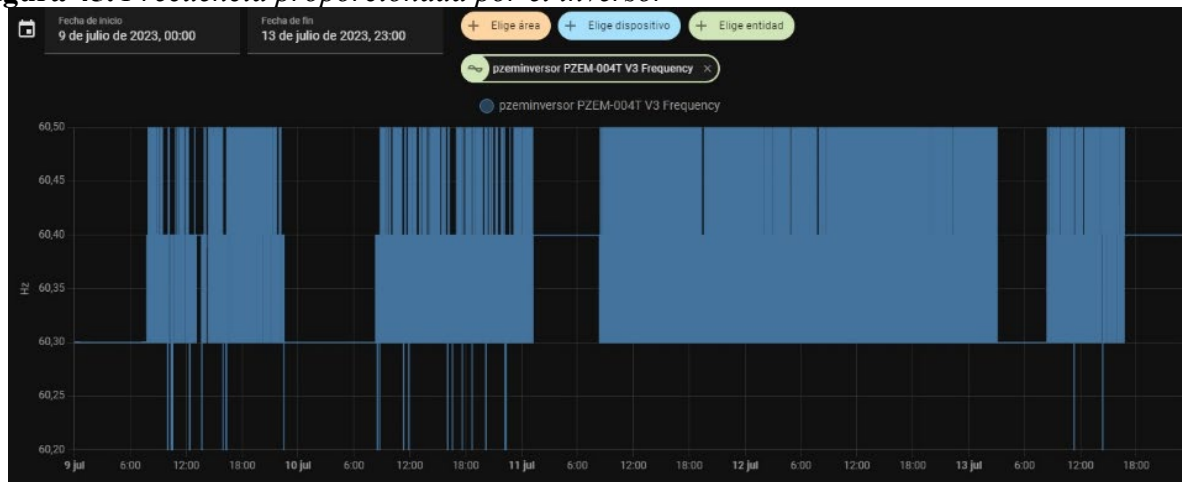
Figura 45. Frecuencia proporcionada por el inversor
