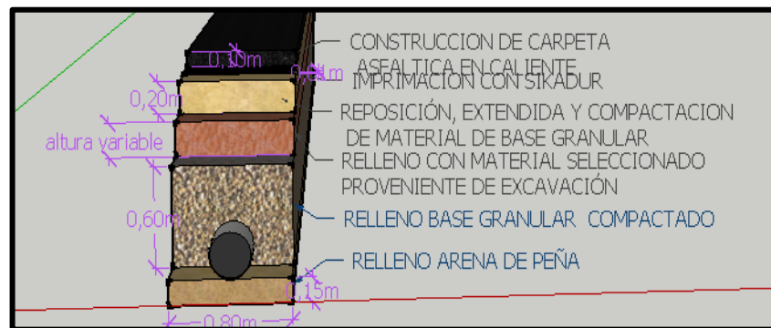
Ilustración 8 Corte con materiales de relleno e instalación.
