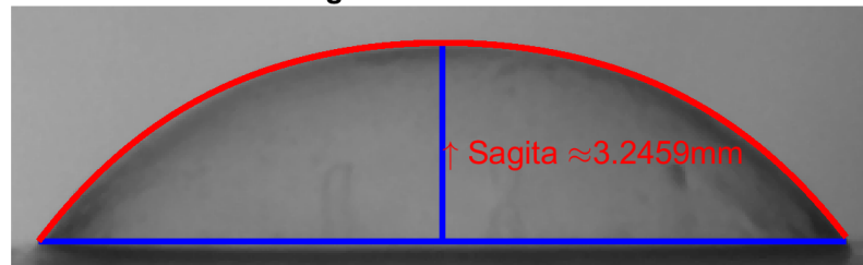
Figura 23. Detección de la curvatura y la sagita del lente de contacto Sagita del lente ODB4
