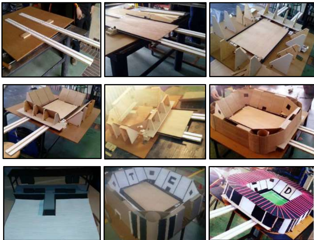
Figura 2: Prototipo a escala del mecanismo de cambio de escenarios de un estadio.
