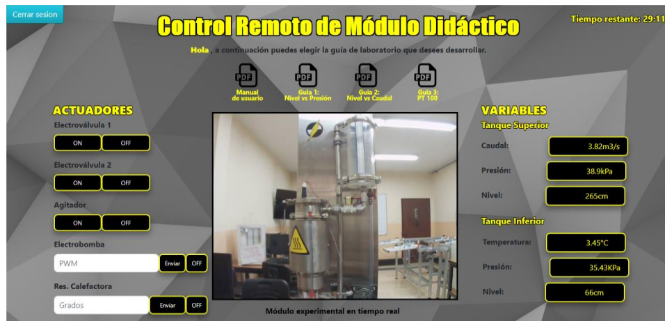
Figura 17. Interfaz de la aplicación web para el manejo del módulo educativo. Imagen tomada por autores.
