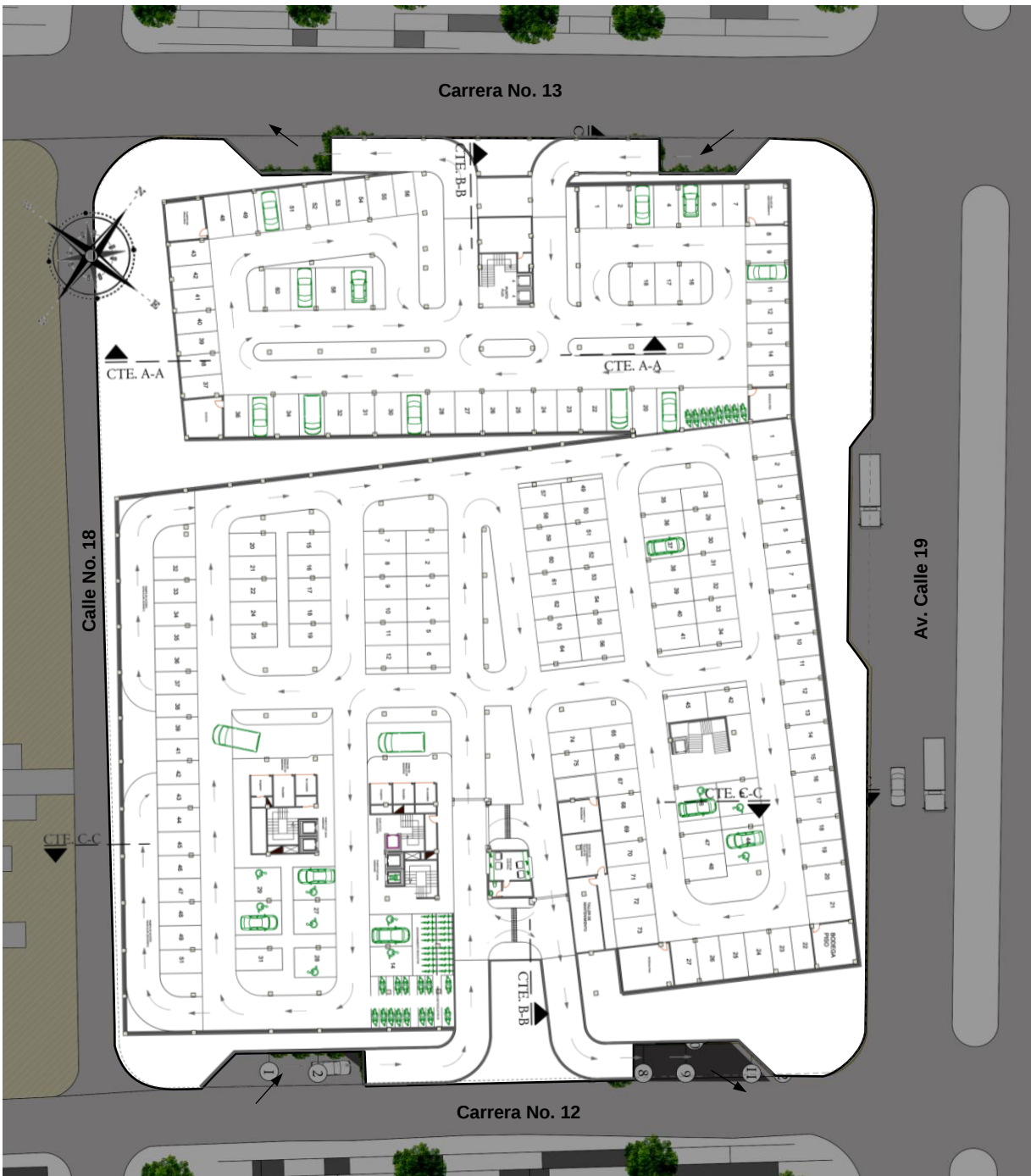
Plano 5. Plantan sótano de estacionamientos vehiculares.
