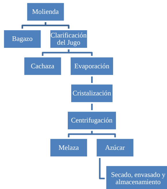
Figura 5. Proceso de producción del azúcar blanco
