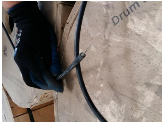
Figura 5. Fibra óptica Drop Canalización 4 hilos elaboración propia.
