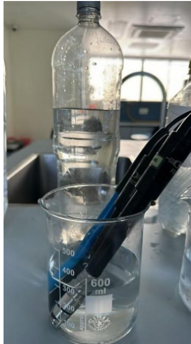
Figura 8. Toma de pH en muestra de agua de la IE
