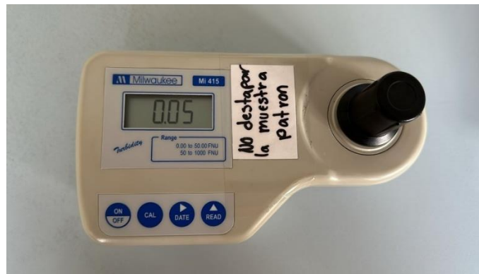
Figura 10. Ensayo para determinación de turbidez
