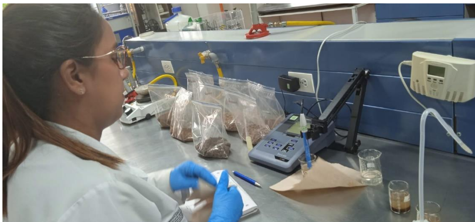
Figura 15. Determinación de PH del Suelo
