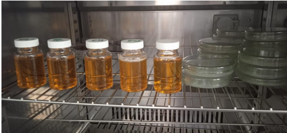
Figura 12. Detección simultánea y confirmativa de coliformes totales
