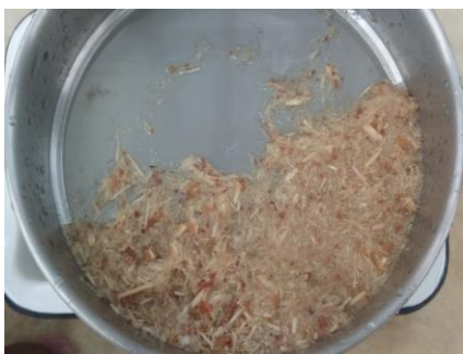
Figura 17 Lavado de biomasa pretratada
