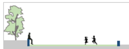
Murete con desnivel deprimido
