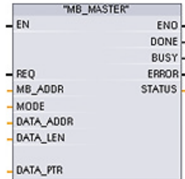
Figura 15. Instrucción en TIA PORTAL para declaración de maestro Modbus
