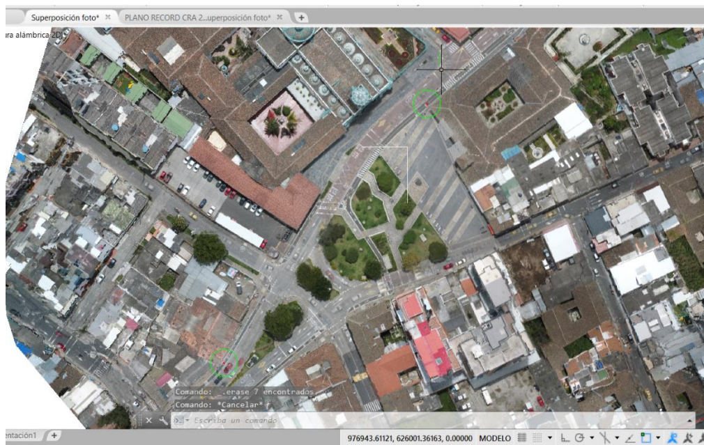
Figura 38. Ortomosaico llevado a escala y coordenadas según los puntos de control
