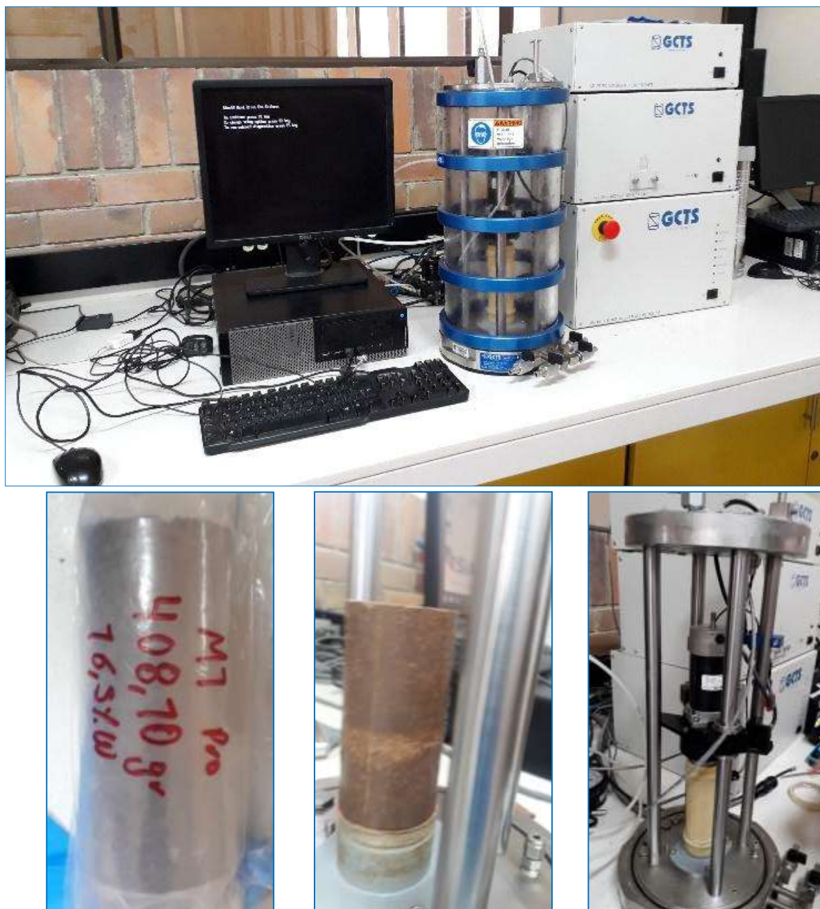
Figura 7. Equipo de Columna Resonante y espécimen ensayado
