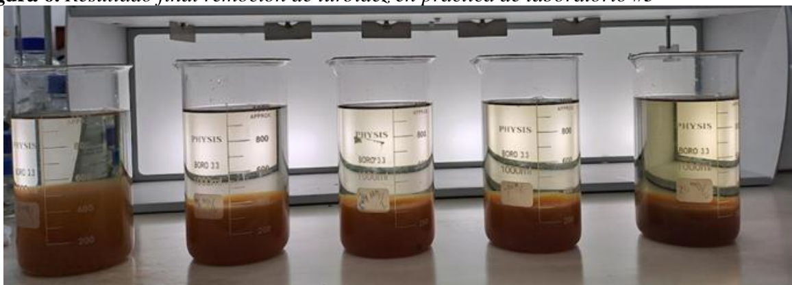
Figura 6. Resultado final remoción de turbidez en práctica de laboratorio #3
