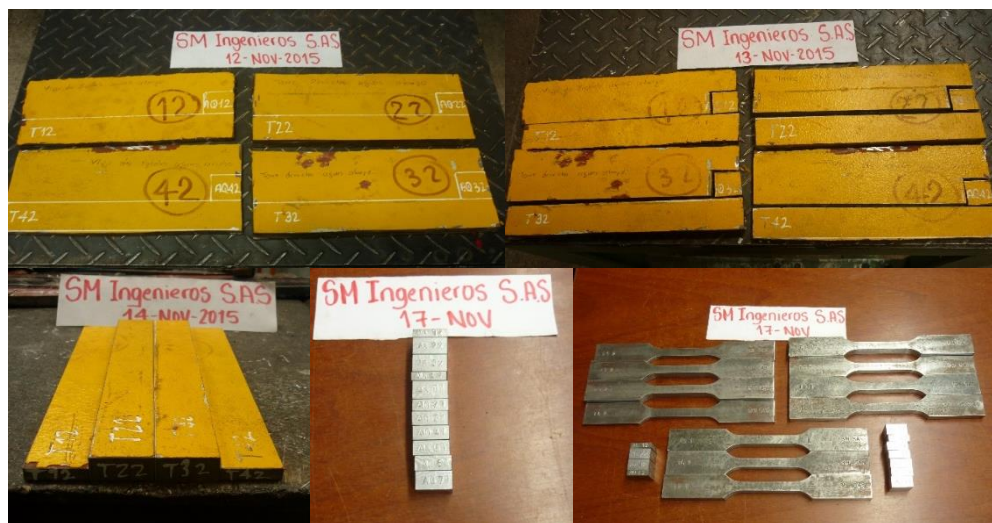
Imagen 25. Probetas tomadas de las columnas de las torres del puente. Fuente: Instituto Nacional de Vías, Consortio IPV, SM Ingenieros SAS, SENA. 2015. Ensayo tensión.
