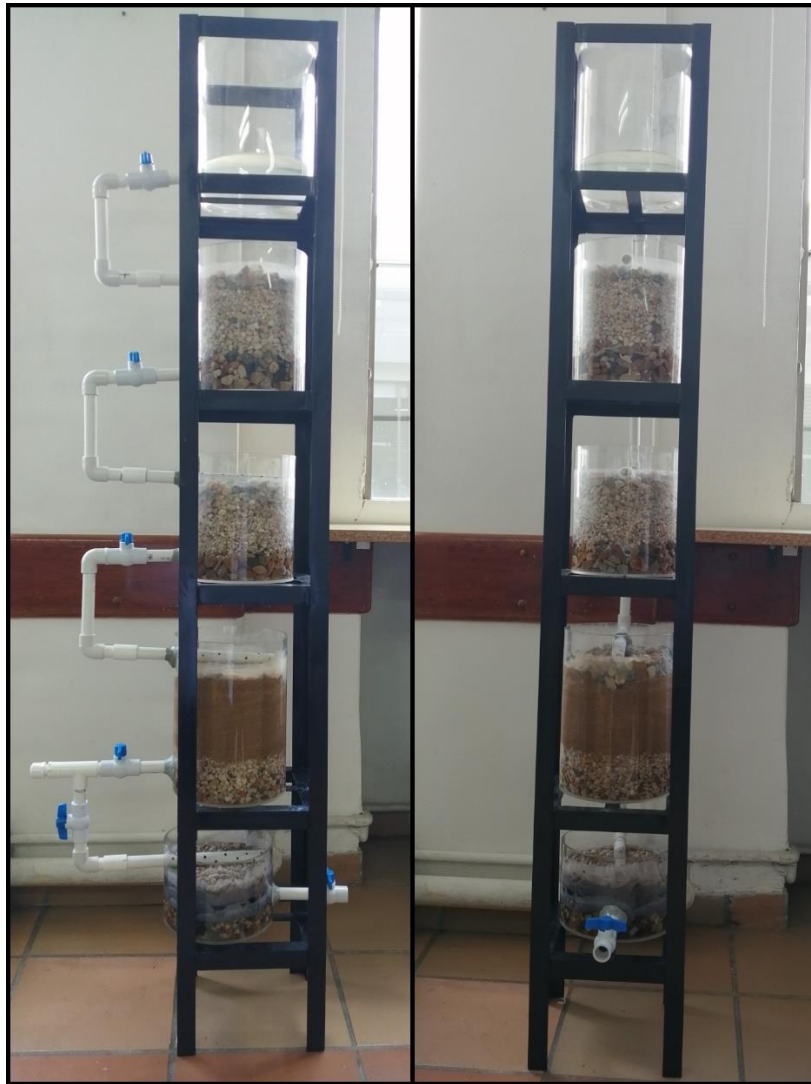
Figura 6. Sistema de filtración a escala laboratorio
