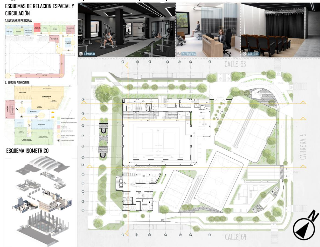
Figura 69. Planta Arquitectónica de primer piso
