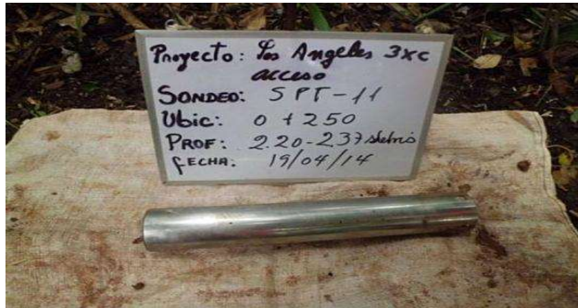
Imagen 7 Identificación y etiquetado. Fuente: Ingecon.
