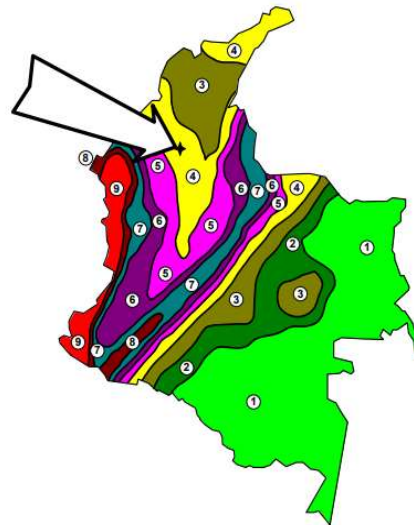
Figura 2 - Representación esquemática ilustrativa del procedimiento de localización dentro del mapa de valores de A_a y A_v del Capítulo A.2
