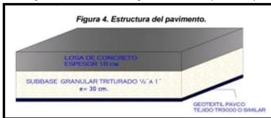
Figura 11. Imagen anexada al informe geotécnico del espesor del pavimento.
