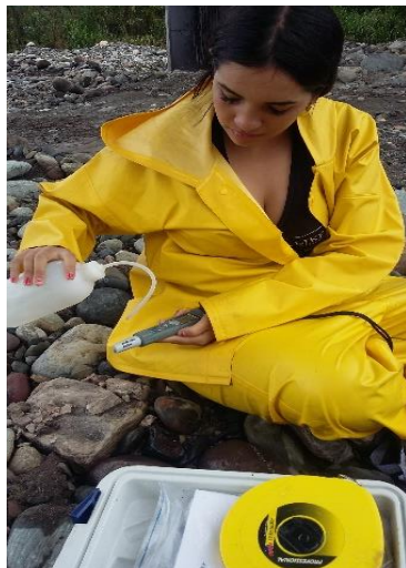
Ilustración 3. Limpieza del Multiparámetro
