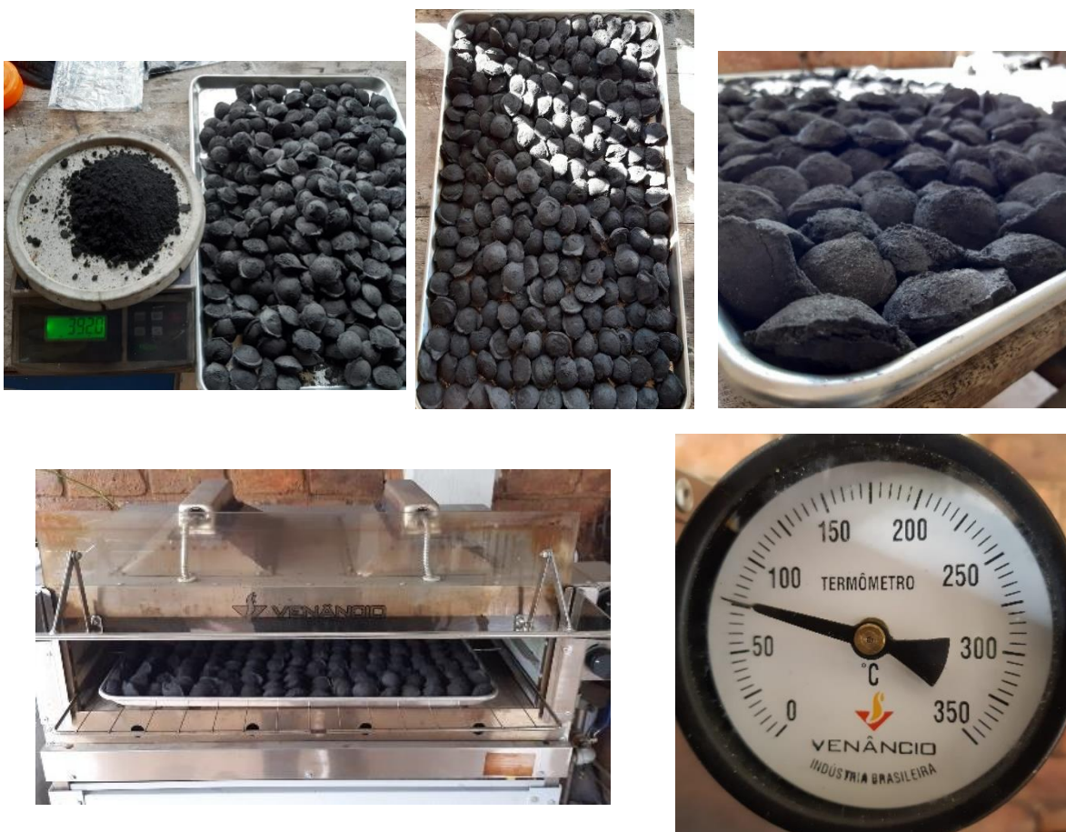
Figura 15. Temperatura y tiempo de curado de las briquetas compactas.
