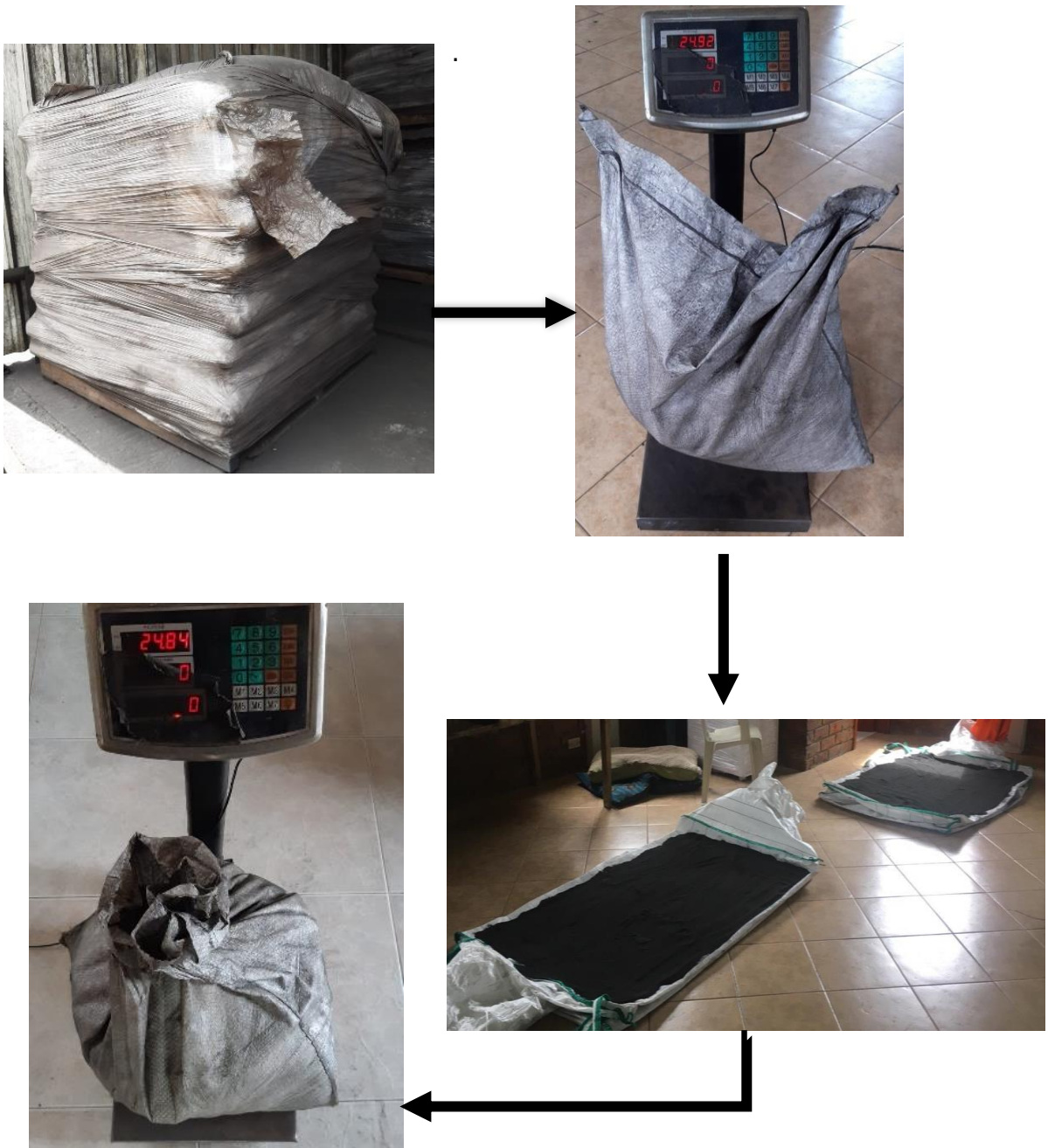
Figura 7. Desarrollo de la actividad dos, selección del fino de coque, peso y desprendimiento de humedad extrínseca.
