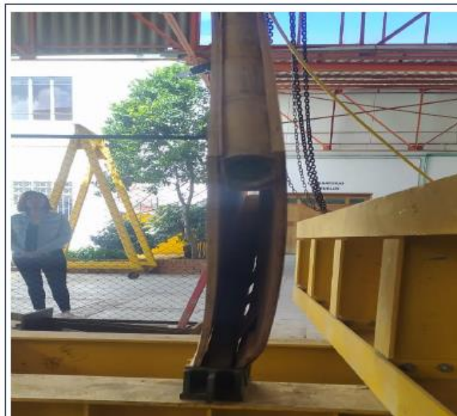
Ilustración 37. Falla de Panel 1.
