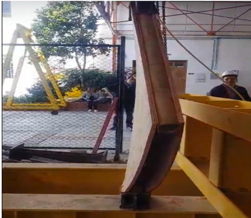
Ilustración 36. Secuencia falla Panel 8.
