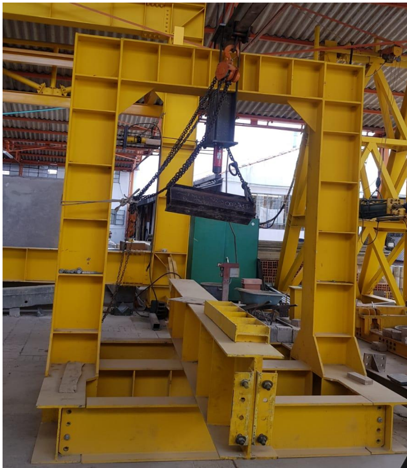
Ilustración 23. Montaje de la estructura para ensayo.
