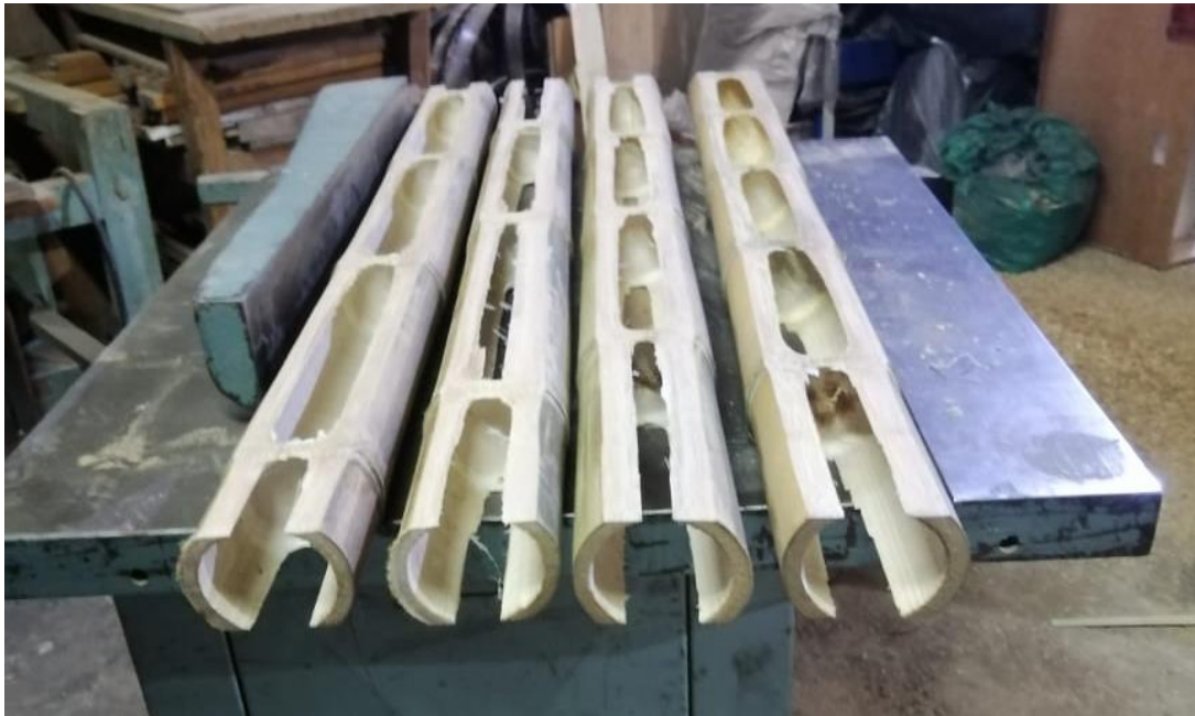
Ilustración 14. Etapa de corte de Guadua Longitudinal.
