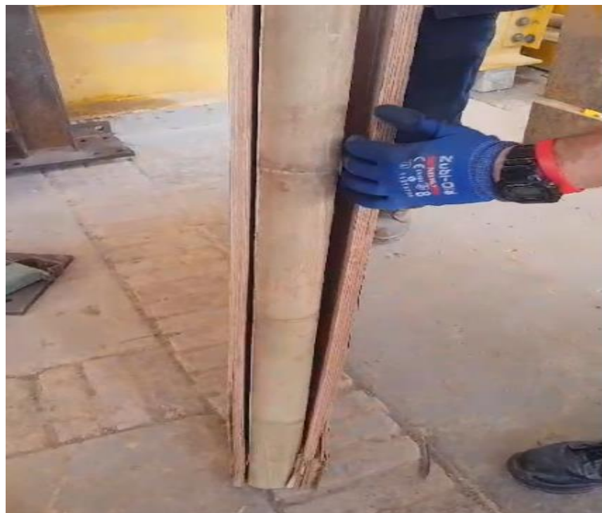
Ilustración 42. Falla de Panel 6.
