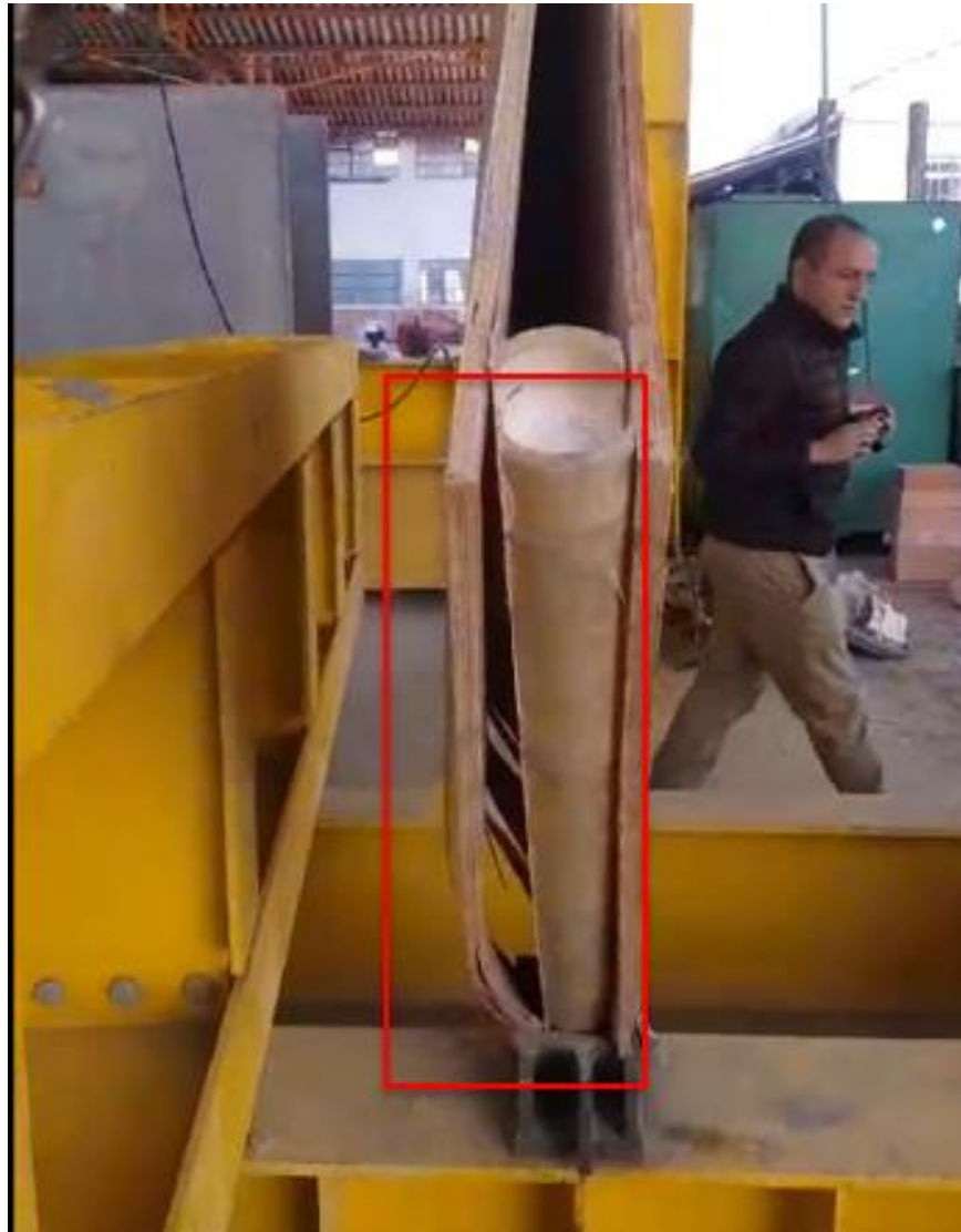
Ilustración 39. Falla de Panel 3.
