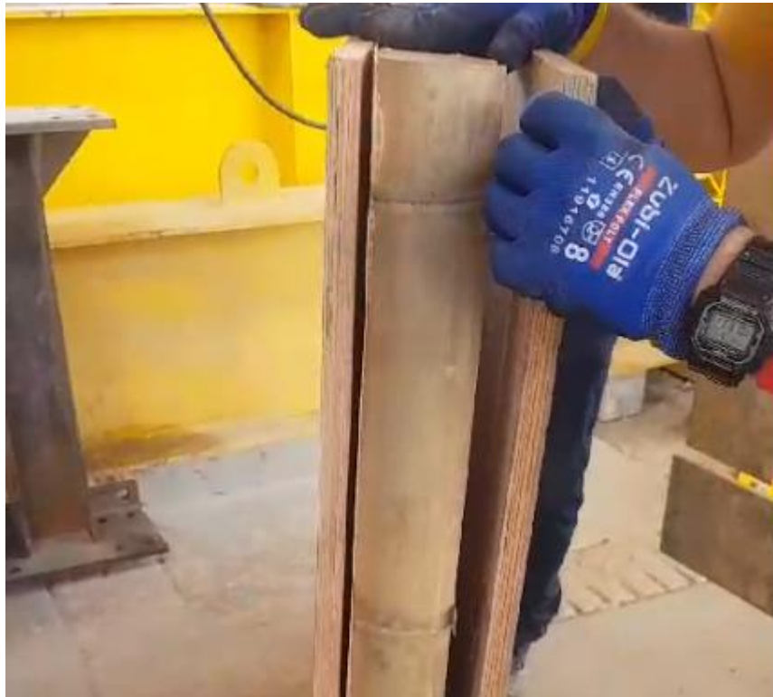
Ilustración 42. Falla de Panel 6.
