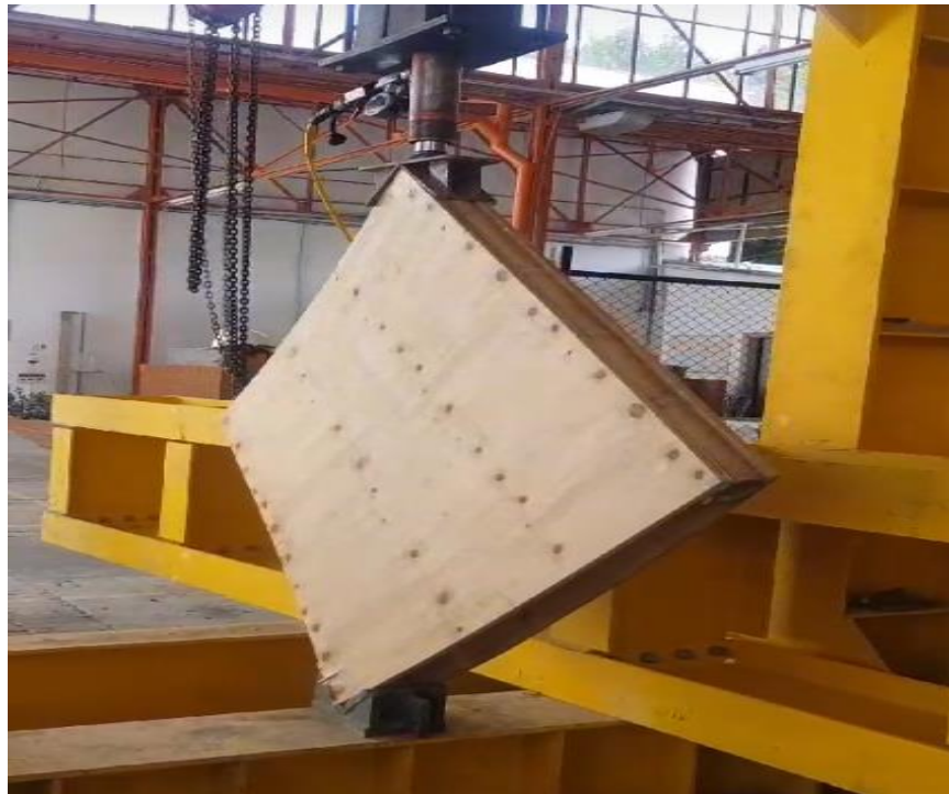
Ilustración 34. Secuencia falla Panel 6.
