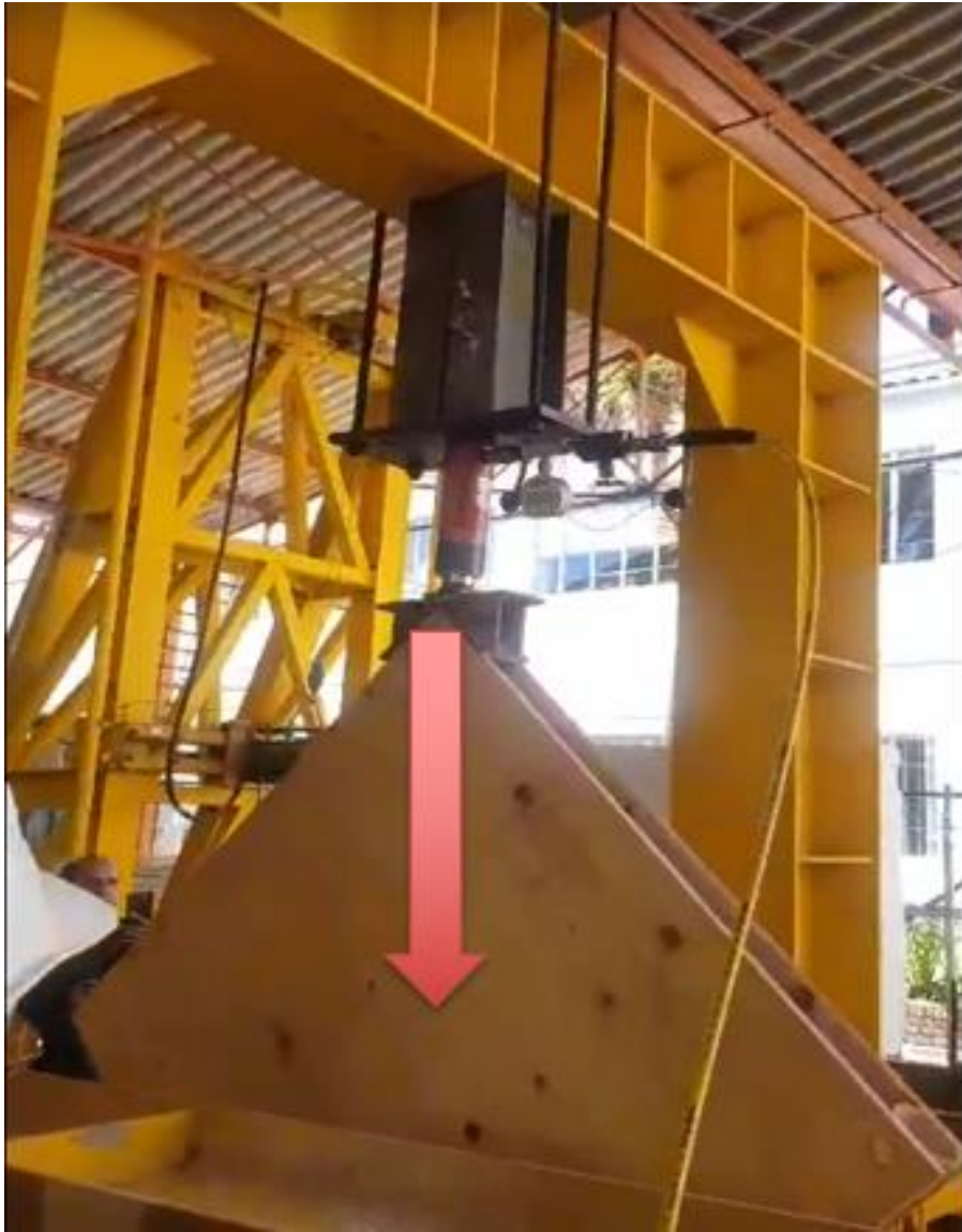
Ilustración 28. Dirección de la fuerza ejercida al panel.
