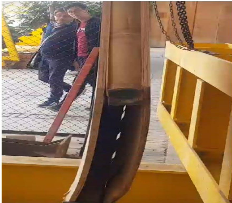
Ilustración 36. Secuencia falla Panel 8.
