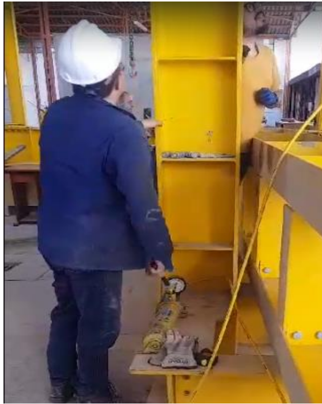
Ilustración 26. Detalle de presión con gato hidráulico por funcionario UNAL.
