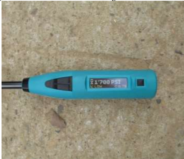
Figura 68. Prueba 2 Esclerometria digital losa sobre el Tablero
