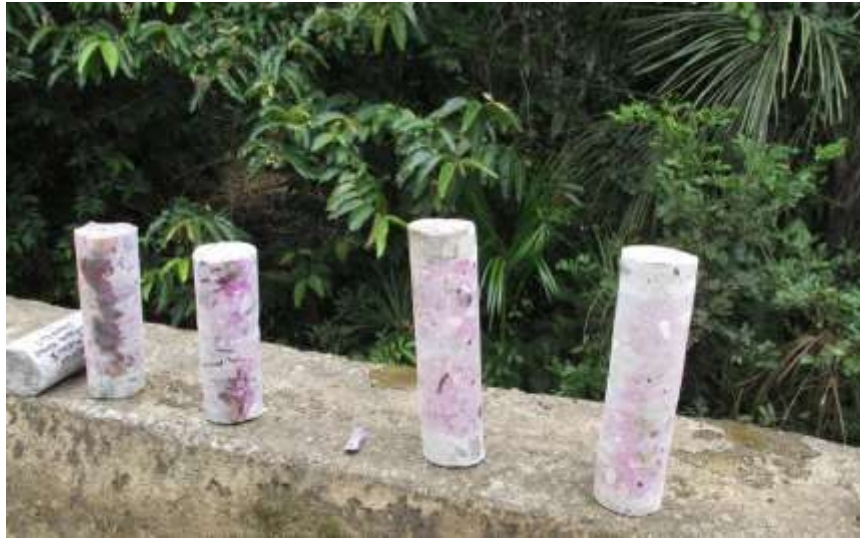
Figura 51. Obtención del frente de carbonatación en diferentes sitios
