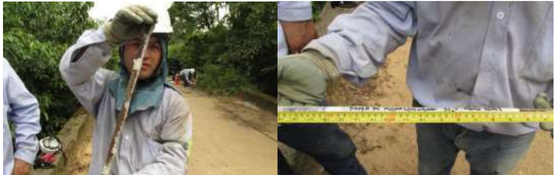
Figura 70. Barra extraída de la losa del puente Manacal
