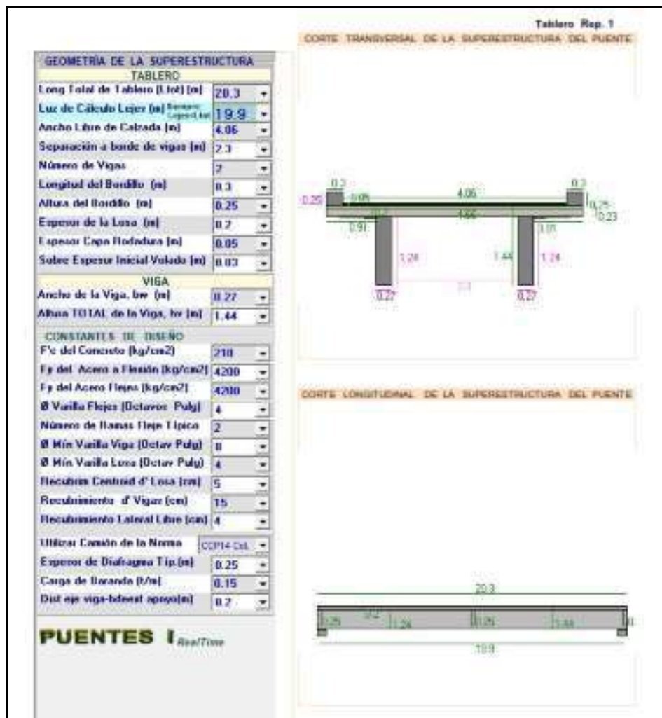
Figura 74. Datos de entrada para el modelo estructural de acuerdo a la información
