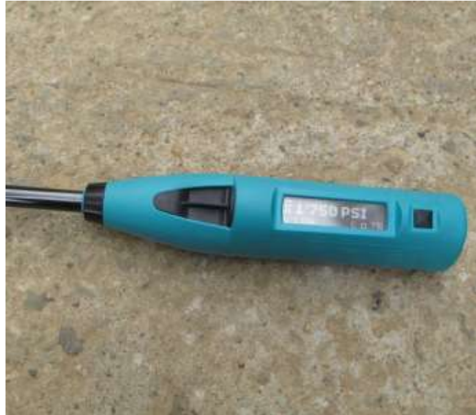
Figura 67. Prueba 1 Esclerometria digital losa sobre el Tablero
