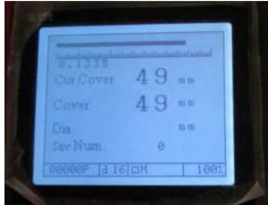
Figura 42. Detalle de lectura de recubrimiento de la losa en la zona inferior con un recubrimiento máximo de 49 mm.
