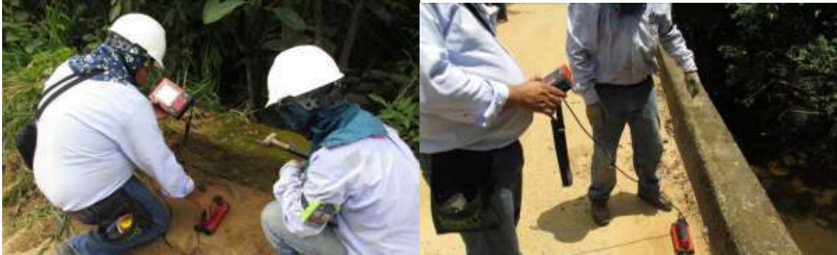
Figura 55. Procedimiento de escaneo de losa de la superestructura parte superior
