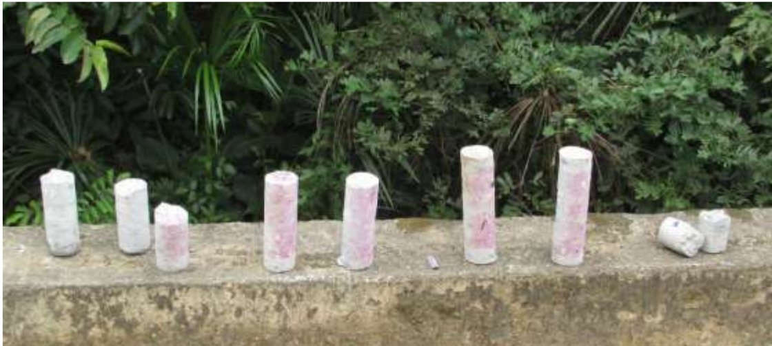
Figura 69. Extracción de núcleos puente sobre caño Manacal ingreso al pozo exploratorio Santa 1
