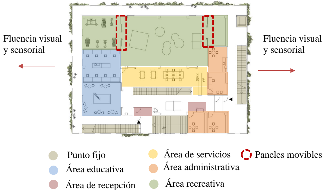
Figura 45. Planta arquitectónica piso 3 Centro Comunitario Máj
