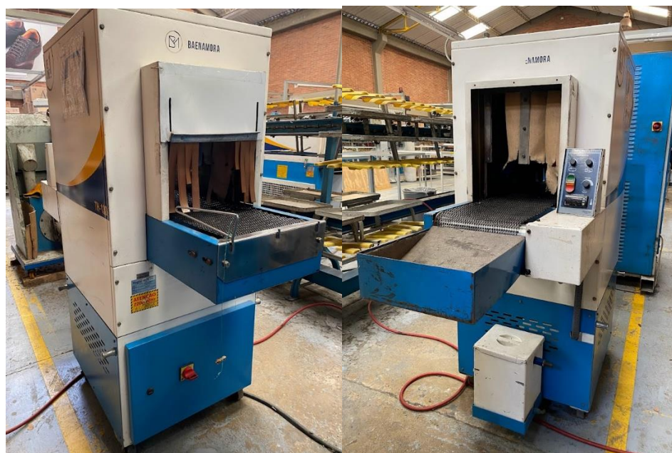
Fig. 16. Horno Conformador TH-130
