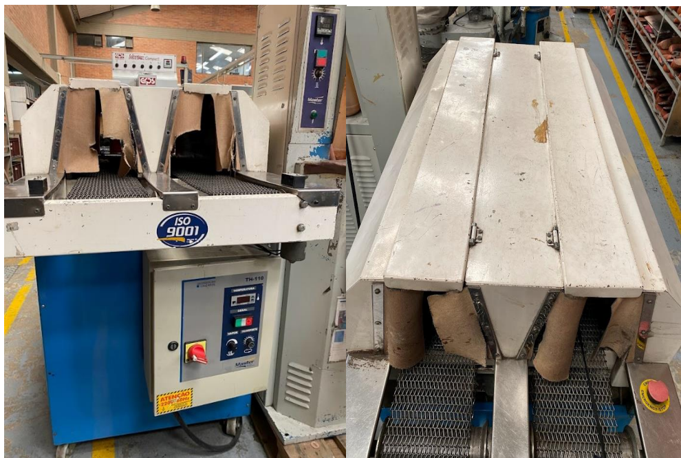
Fig. 13. Horno Conformador Doble Banda TH-100
