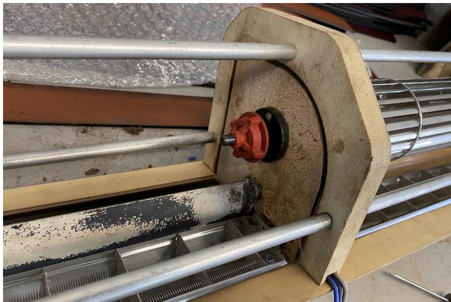
Fig. 21. Acoples o bloqueos de caucho de ventiladores
