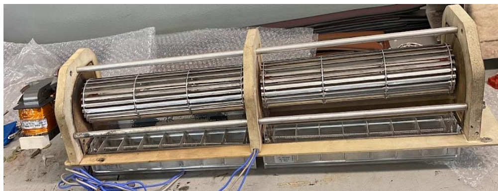
Fig. 20. Ventiladores y Resistencias de Horno TGV-20
