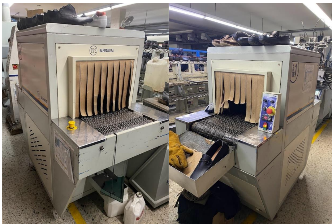
Fig. 15. Horno Conformador TH-40
