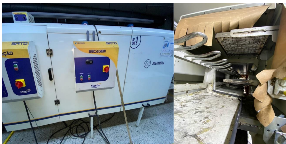
Fig. 17. Horno Secador Reactivador SRTD
