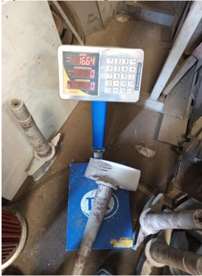
Figura 9. Toma de peso de alabes previo a trabajos de soldadura
