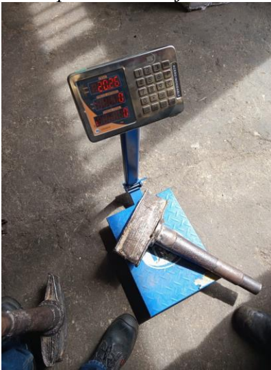
Figura 10. Toma de peso de alabes después de trabajos de soldadura
