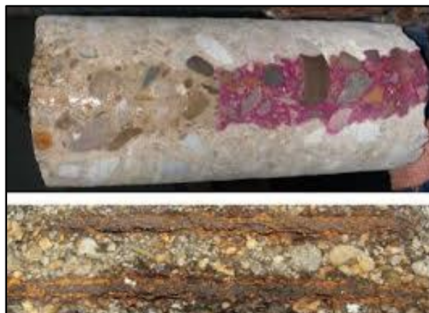
Fotografía 37. Ejemplo de núcleo con fenolftaleína
