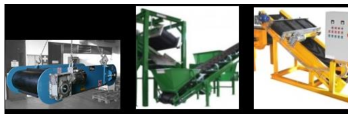
Figura 10.1. Separación del acero o desmetalizado
