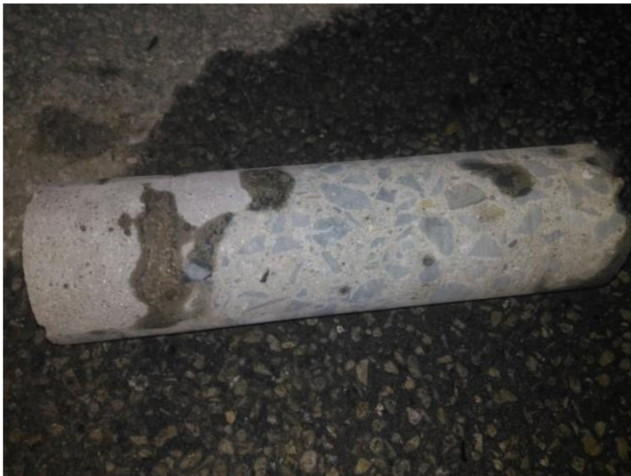
Figura 12. Apreciación de sobre losa durante la extracción de núcleos.
