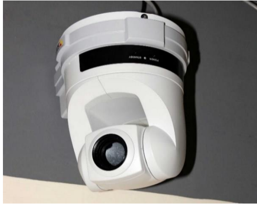
Ilustración 18 Cámara tipo PTZ.
