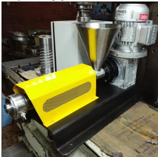
Imagen 11. Equipo de extrusión ensamblado
