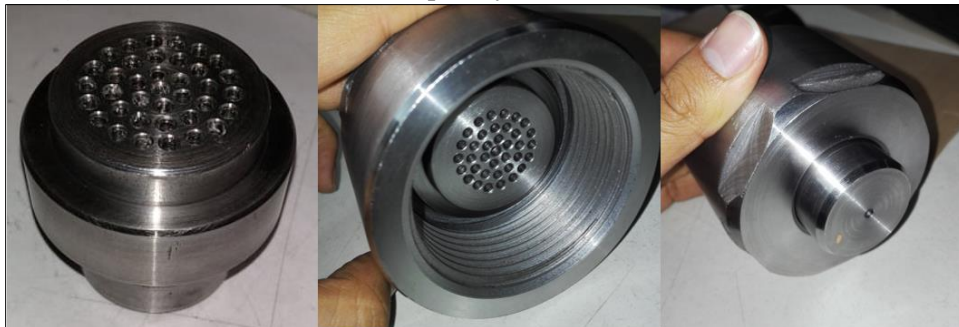
Imagen 10. Ensamble de disco, boquilla y cabezal
