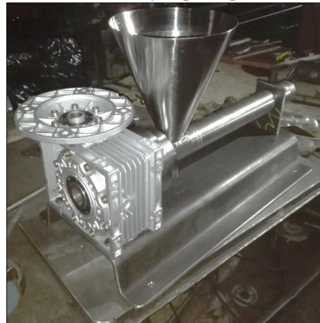
Imagen 8. Tolva y soporte para motor
