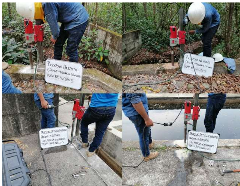
Fotografía 14 Extracción de núcleos bocatoma y desarenador Huerta La Grande
