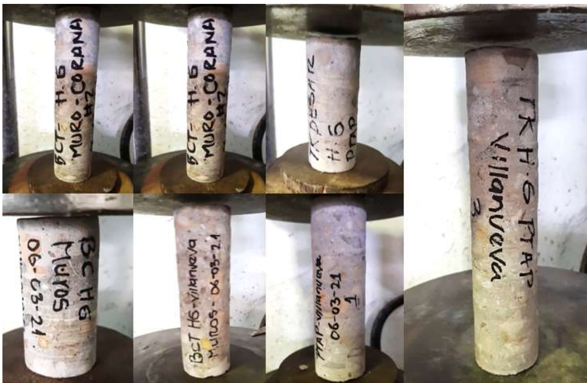
Fotografía 15 Fallo de núcleos 1 a 7 bocatoma y desarenador Huerta La Grande
