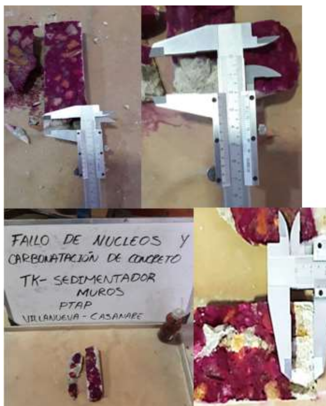
Fotografía 10 Ensayo de Carbonatación núcleos 1, 2, 3 y 4 bocatoma y sedimentador Caño Claro
