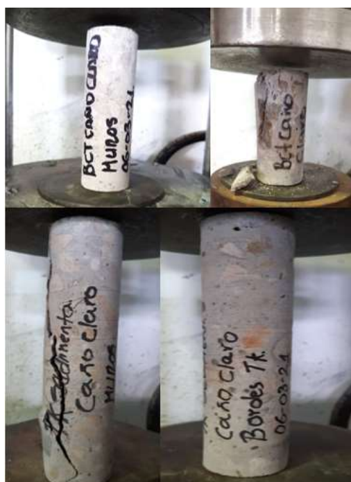
Fotografía 9 Fallo de núcleos 1, 2, 3 y 4 bocatoma y sedimentador Caño Claro
