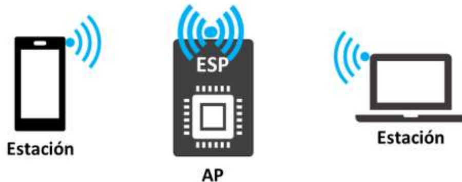
Figura 10 Modo punto de acceso en ESP8266 [15] Fuente: Grokhotkov, Ivan, "ESP8266 Documentación Arduino Core", 2017.
