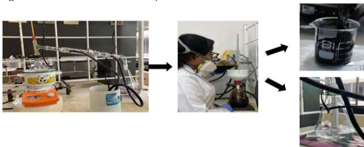
Figura 11. Proceso de destilación del asfalto
