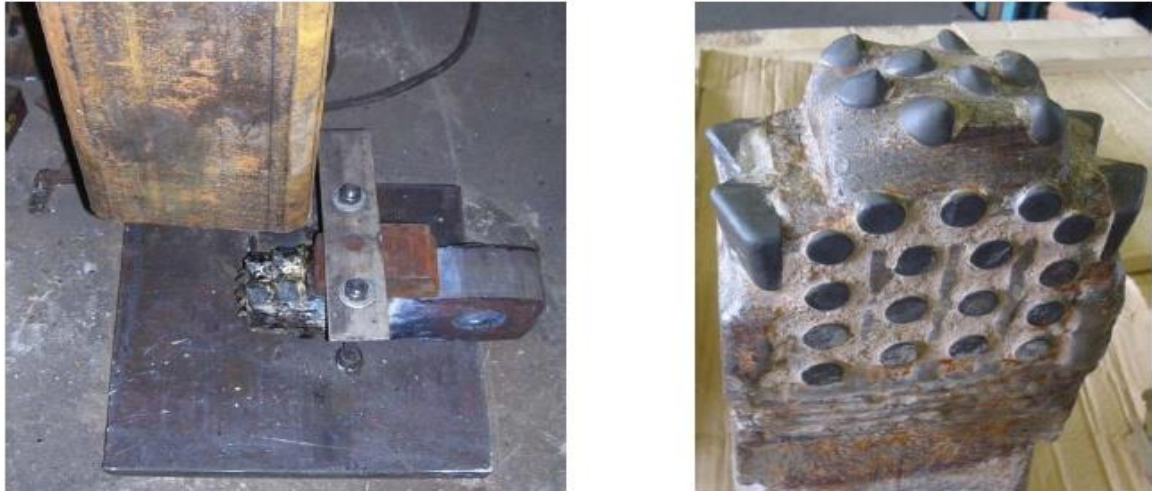
Figura 34. Ensayo Drop test. Muestra de herramientas reales, para ensayos. (Lovat, Inc., 2009).
