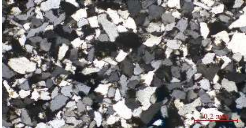
Microfotografía 18. (Nicoles cruzados). Nótase el tamaño de los granos, entre 0.14 mm - 0.2mm.
