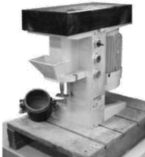
Figura 27. Aparato de ensayo LCPC (Mathier, 2002).
