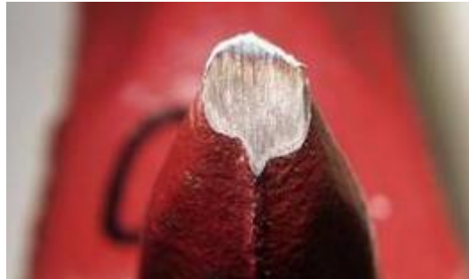
Figura 38. Desgaste de herramienta después de ensayo.
