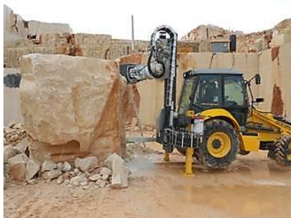
Figura 45. Cortadora portátil sobre retroexcavadora.
