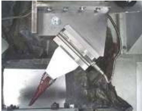
Figura 40. Equipo de laboratorio para la realización de los ensayos de desgaste. Fuente:Fuente: Rendimiento, desgaste y abrasividad en excavación..(González, p, 2014).
