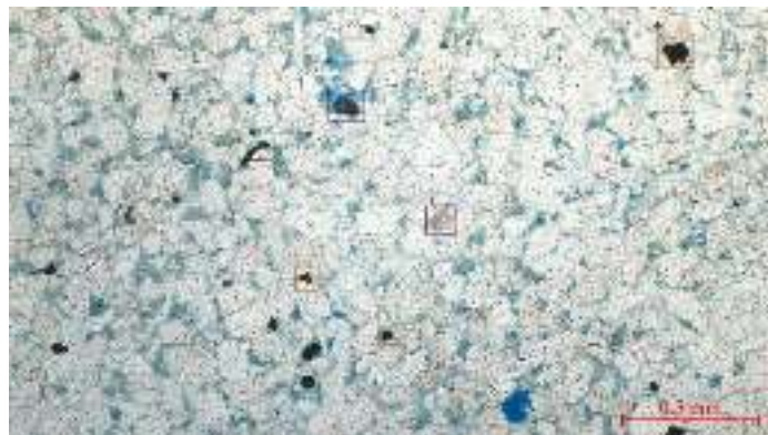
Microfotografías 5. (Foto nicols paralelos) Recuadros: Azul: Turmalina, Naranja: Minerales opacos, Violeta: Glauconita (Oolitos).
