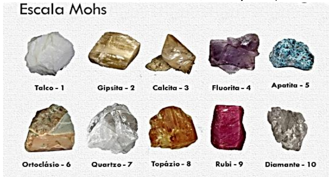
Figura 51. Esquema de la escala de Mohs.
