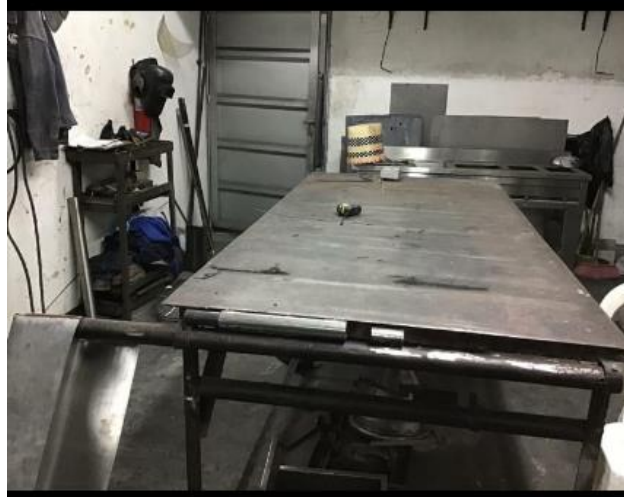
Figura 19. Mesa de trabajo de soldadura
