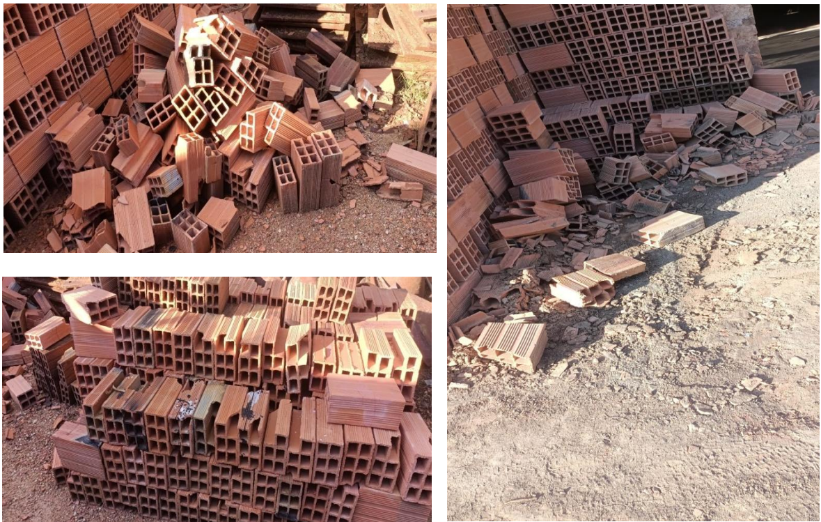
Ilustración 3 Evidencia ladrillos defectuosos
