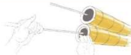
Figura 44. Relleno con grout.
