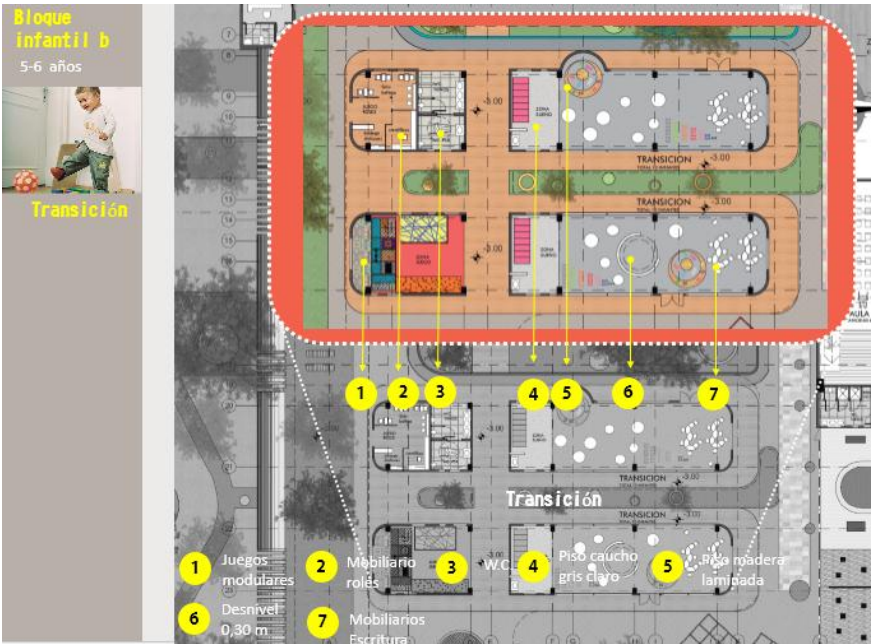
Figura 125. Especificaciones materiales Transición
