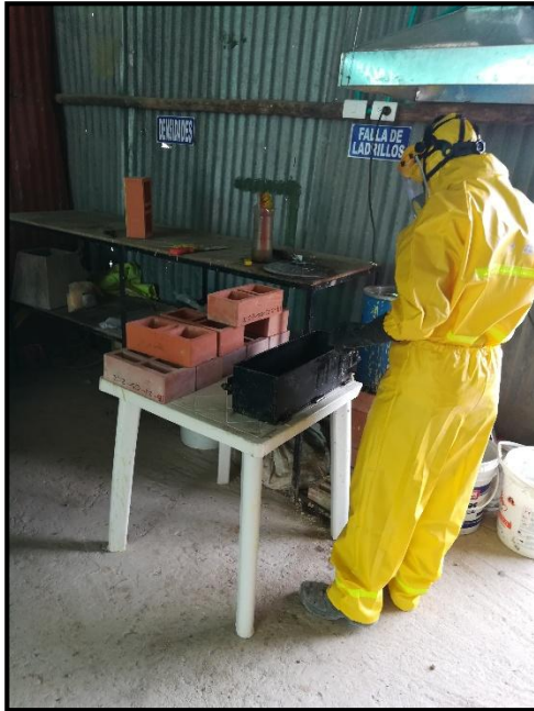
Fotografía 35. Ensayo de compresión y absorción de los ladrillos.
