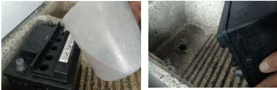
Fotografía 10. Lavado total y reincorporación del ácido sulfúrico ( H_2SO_4 ) Fuente: Autores
