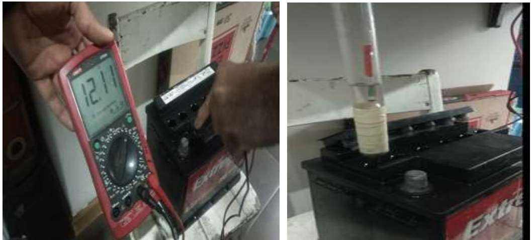
Fotografía 11. Verificación de reacondicionamiento de batería
