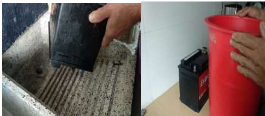
Fotografía 6. Lavado de la batería Fuente: Autores
