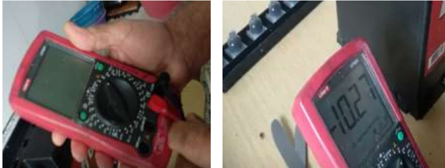
Fotografía 5. Comprobación capacidad de carga de la batería Fuente: Autores
