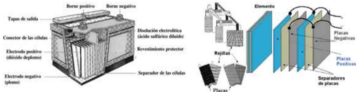
Gráfica 3. Esquema básico de una batería de plomo-ácido.
