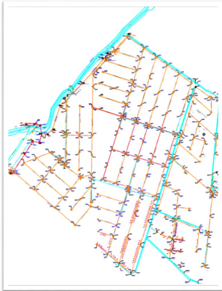
Ilustración 29 Red de Drenaje
