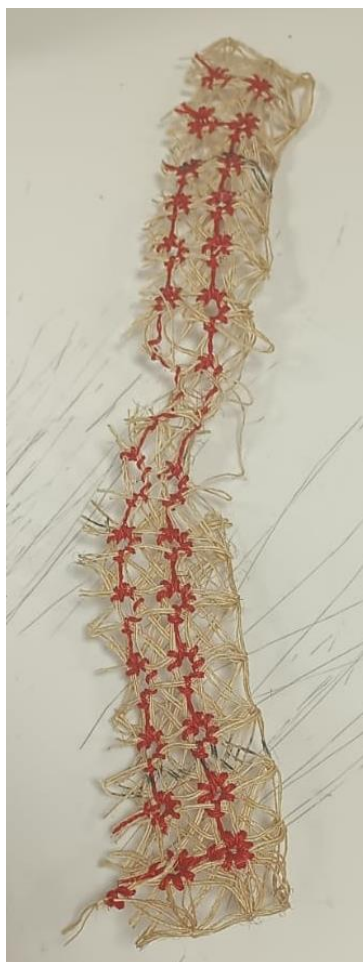
Ilustración 49:Fibra fallada por la maquina universal fuelle: Propia
