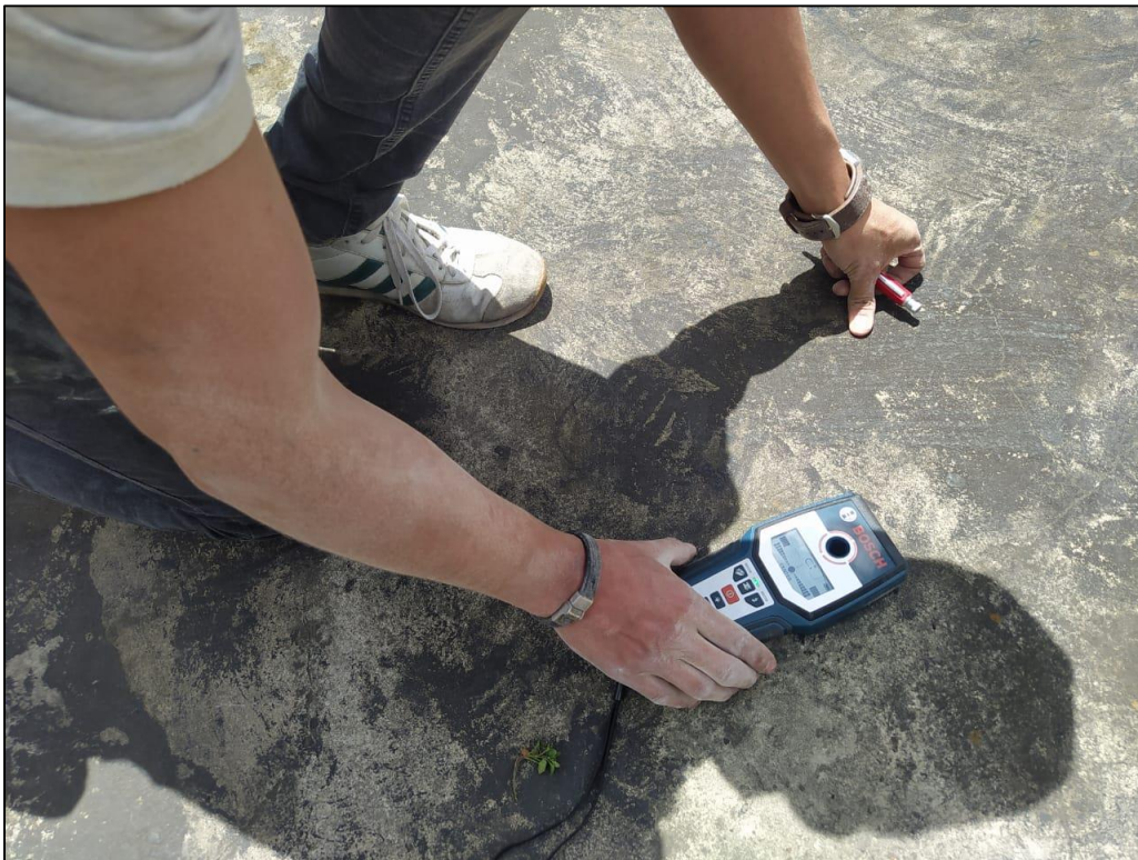
Ilustración 16. Localización del acero con Pacómetro
