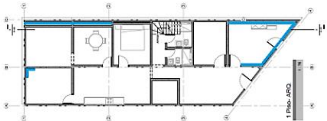
Ilustración 9. Localización de daños (Humedad – Capilaridad). Fuente propia
