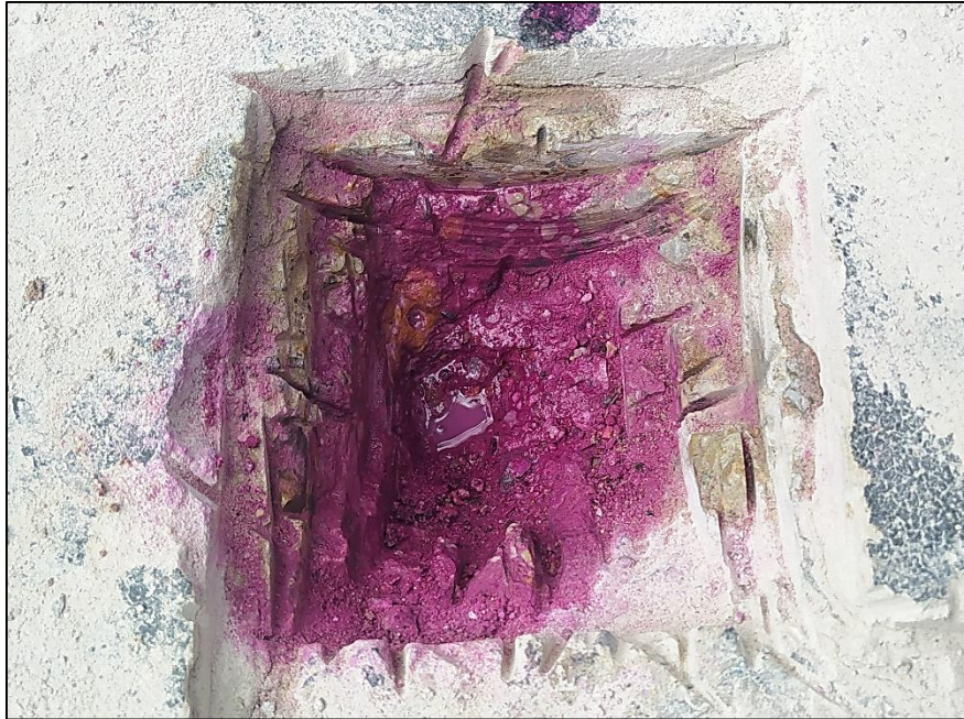
Ilustración 24. Aplicación de revelador de pH. Fuente Propia
