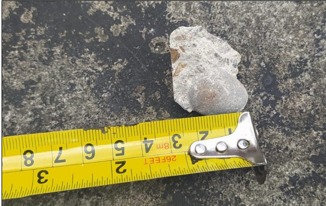
Ilustración 26. Tamaño máximo de agregado. Fuente Propia
