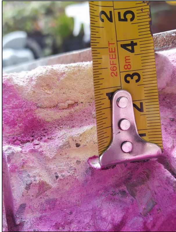
Ilustración 25. Avance del frente de carbonatación. Fuente propia
