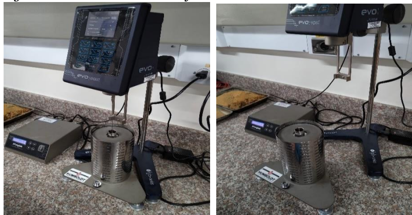
Figura 10.10 Viscosidad del asfalto mediante el viscosímetro rotacional
