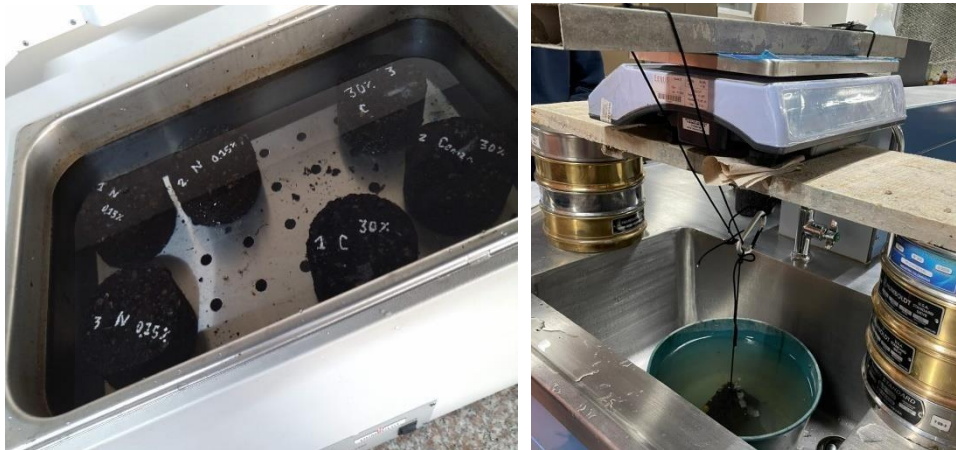
Figura 10.12 Ensayo para determinar la gravedad específica de Bulk
