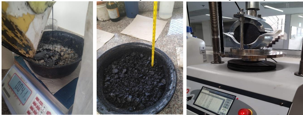
Figura 10.11 Ensayo Marshall para determinar contenido óptimo de asfalto
