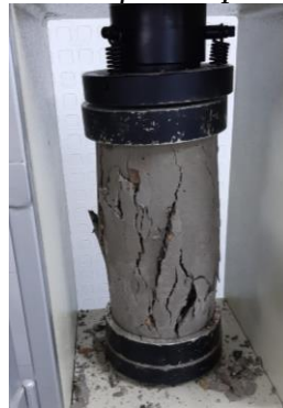
Figura 40. Bloque de concreto con falla Tipo 3.
