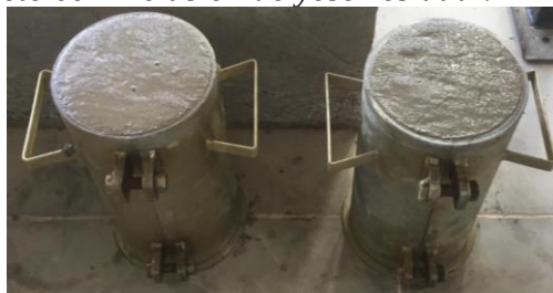
Figura 30. Cilindros de concreto con inclusión de yeso residual.
