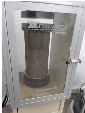
Figura 31. Ensayos a compresión de los bloques de concreto con inclusión de yeso residual.
