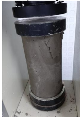
Figura 39. Bloque de concreto con falla Tipo 6.
