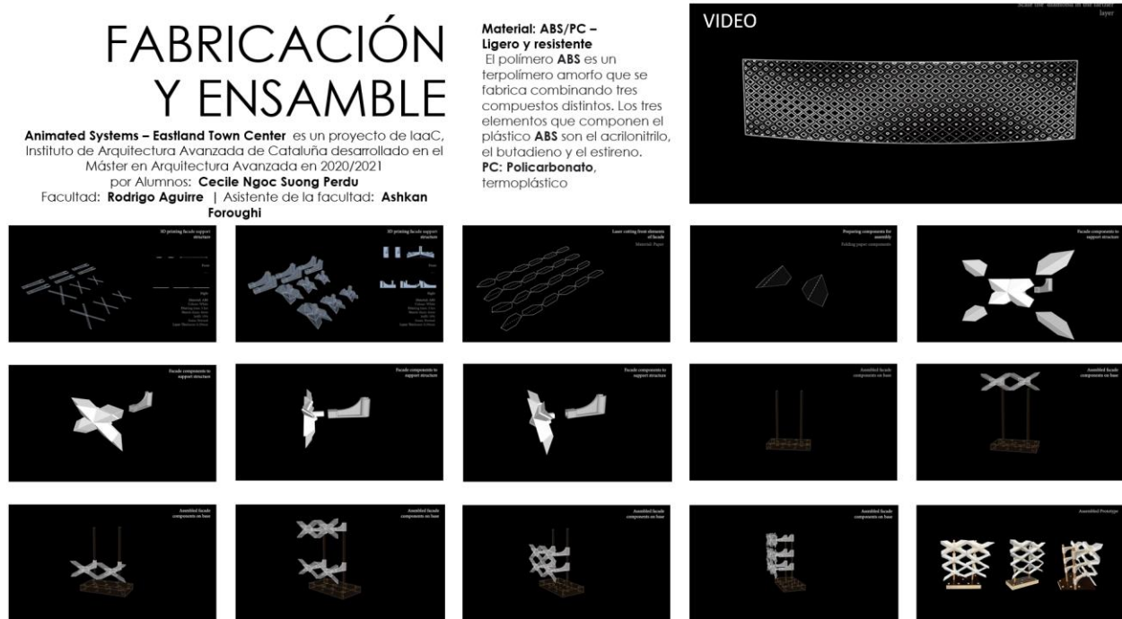
Figura 129. Proceso de fabricación y ensamble de las piezas de la malla
