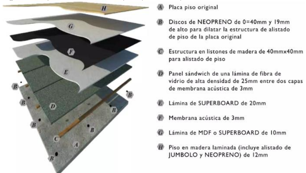
Figura 61. Esquema de aislamiento de pisos (FETB. 2016)
