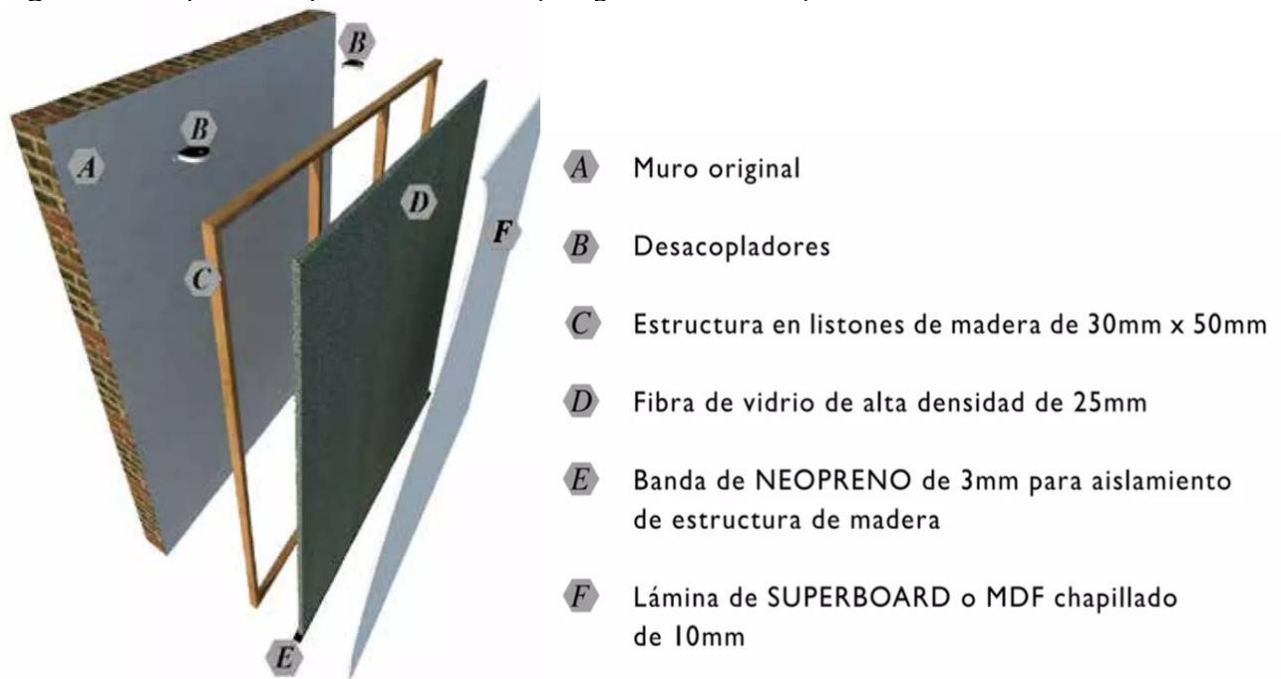
Figura 60. Esquema de paredes aisladas (Imagen FETB. 2016)
