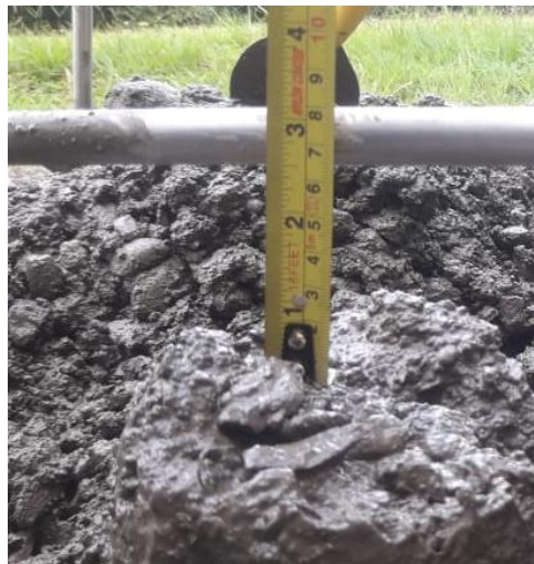
Fig. 6 ASENTAMIENTO DE LA MEZCLA CON 5% DE FIBRA APLICADA
