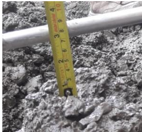
Fig. 4 ASENTAMIENTO DE LA MEZCLA CONVENCIONAL DE 21 MPA
