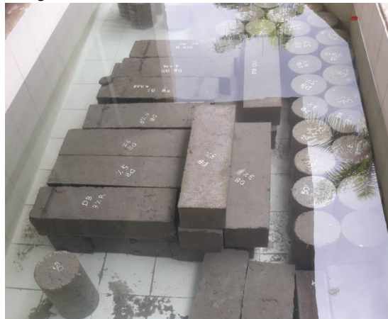
Fig. 8 ESPECÍMENES EN PROCESO DE CURADO
