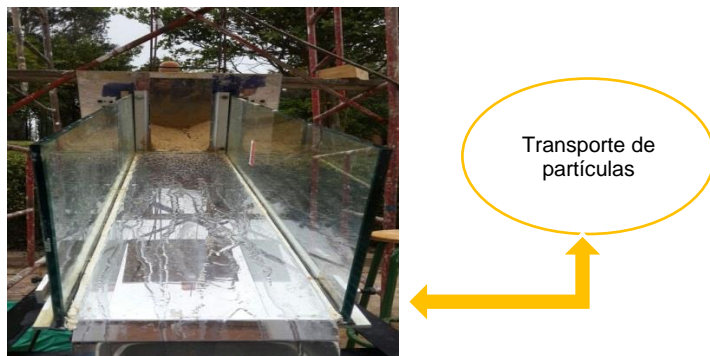
Fotografía 47. Instalación de material en forma de cárcava prueba modelo 3
