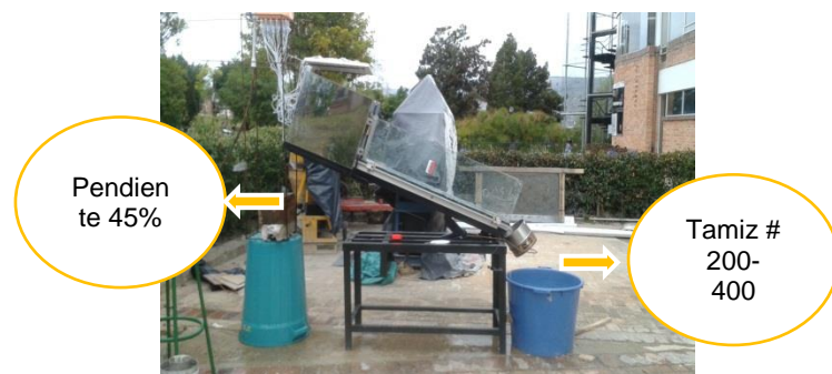
Fotografía 33. Modelo tipo 3 pendiente 45% y 60 mm/hora de precipitación.
