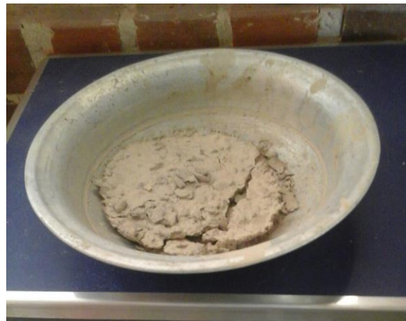
Fotografía 45. Material erosionado con una pendiente del 15% y precipitación de 120mm/h
