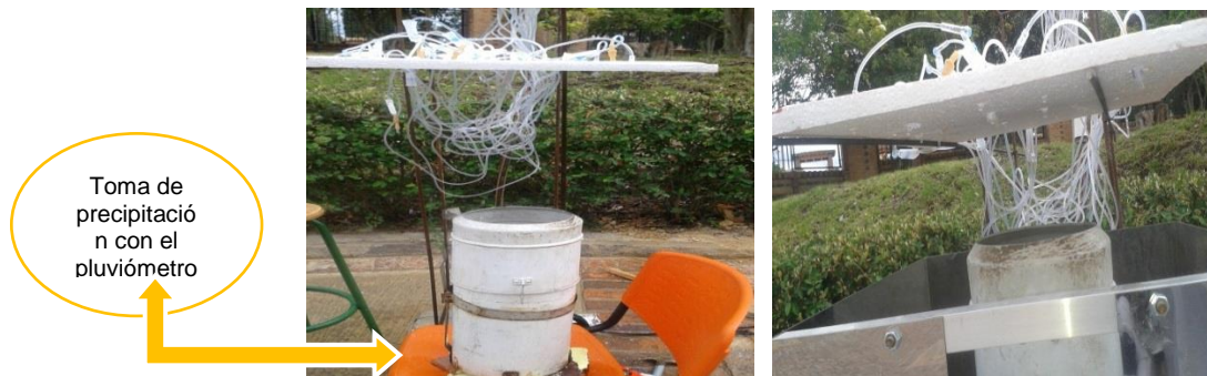
Fotografía 23. Calibración e instalación de precipitación con el pluviómetro
