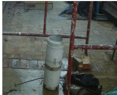
Fotografía 50. Toma de lluvia por medio del pluviómetro. Realizado para el modelo 5
