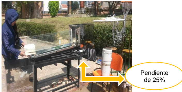
Fotografía 29. Modelo tipo 2 con una pendiente 25%.
