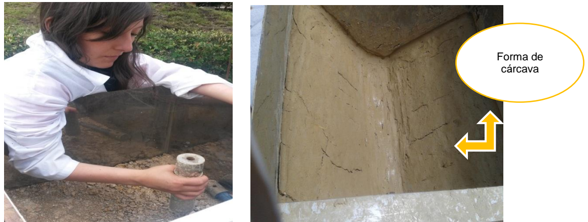
Fotografía 38. Instalación de material en forma de cárcava prueba modelo 3
